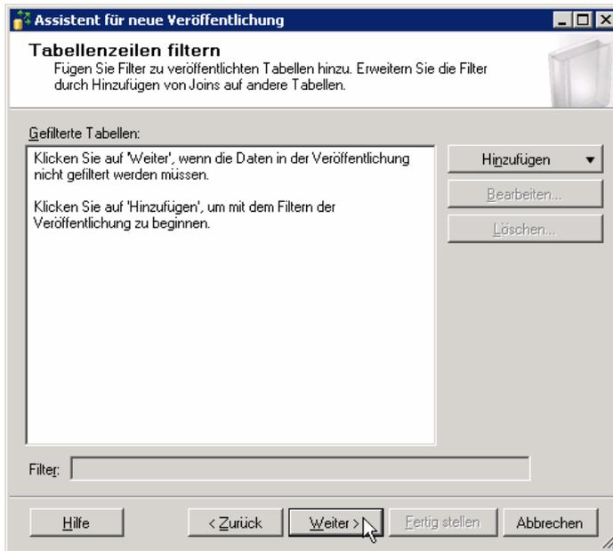
9. Im nächsten Schritt können Sie bestimmen, ob der Anfangs-Snapshot (Momentaufnahme), der bei der Merge-Replikation zwingend erforderlich ist, sofort ausgeführt bzw. erstellt werden soll. Belassen Sie diese Option bitte so. Zusätzlich haben Sie die Möglichkeit einen Zeitplan für die Ausführung des "Momentaufnahme-Agent" festzulegen. Bitte deaktivieren Sie diese Option, um den Momentaufnahme-Agent manuell auszuführen.
